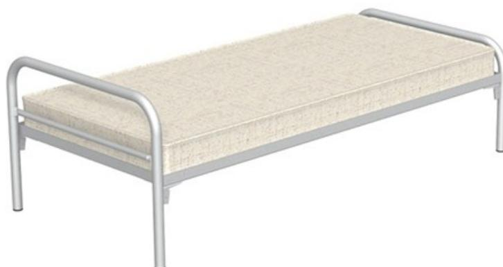
Lit tout métal avec sommier à lattes. 2 montants en tube acier Ø 40 x 1.5 (tête et pied de lit identiques). 4 embouts ? 40 en polypropylène, non tachants. La tête et le pied de lit sont munis de supports de cadre sommier en feuillard acier 50 x 1.5mm, soudés sur les pieds. Blocage par 4 vis M6 + écrous borgnes. Revêtement poudre thermodurcissable à base d'époxy et de polyester. Coloris au choix nous consulter. Garantie 2 ans.
