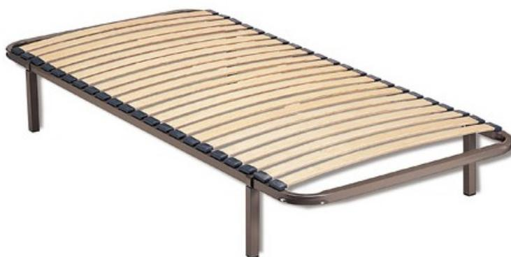
La solution simple et idéale en hôtellerie ou en résidence étudiants. Cadre métal de section 30 X 30 mm équipé de 20 lattes multiplis clipsées sur le dessus du cadre. Lattes multiplis largeur 53 cm X ép. 8 mm. Finition peinture époxy grise. Pieds PVC cylindriques hauteur 22 cm (à commander en plus REF 274658). Positionnement des pieds à 25 cm mini des têtes du cadre.
